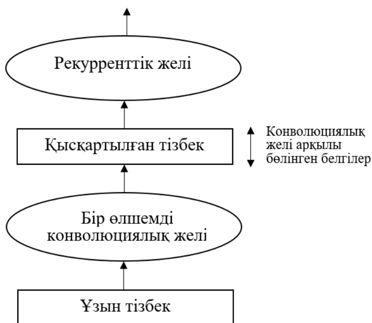
Сурет 2.16 – Ұзын тізбектерді өңдеу үшін бір өлшемді конволюциялық және рекурренттік желілерді біріктіру
